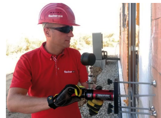
Výtažná zkouška „in situ“ na stavbě
