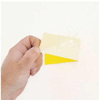
Obr.1 Příp. zkouška přidrženosti podkladních vrstev.
