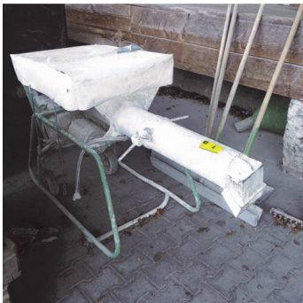
Obr.1 Namíchání malty pomocí kontinuální míchačky nebo míchadla.
