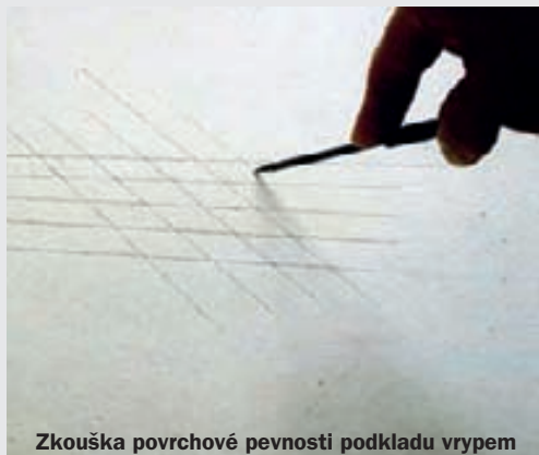
Zkouška povrchové pevnosti podkladu vrypem
