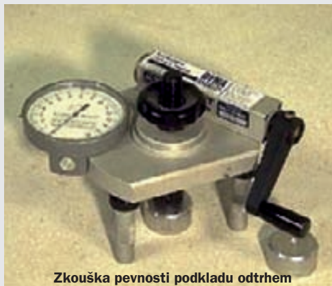
Zkouška pevnosti podkladu odtrhem
