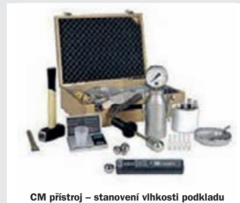
CM přístroj – stanovení vlhkosti podkladu
