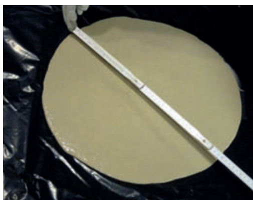
Měření průměru rozlitého potěru
