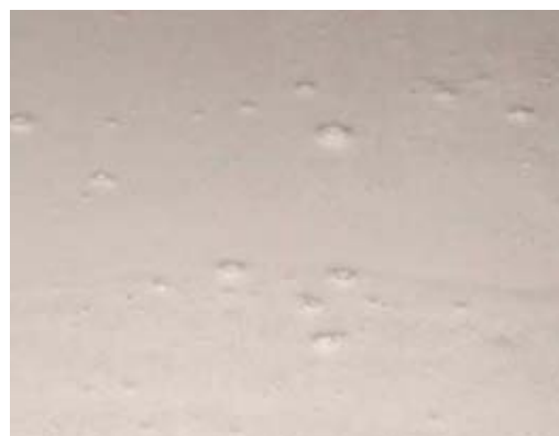
Neodstraněné bublinky vzduchu
