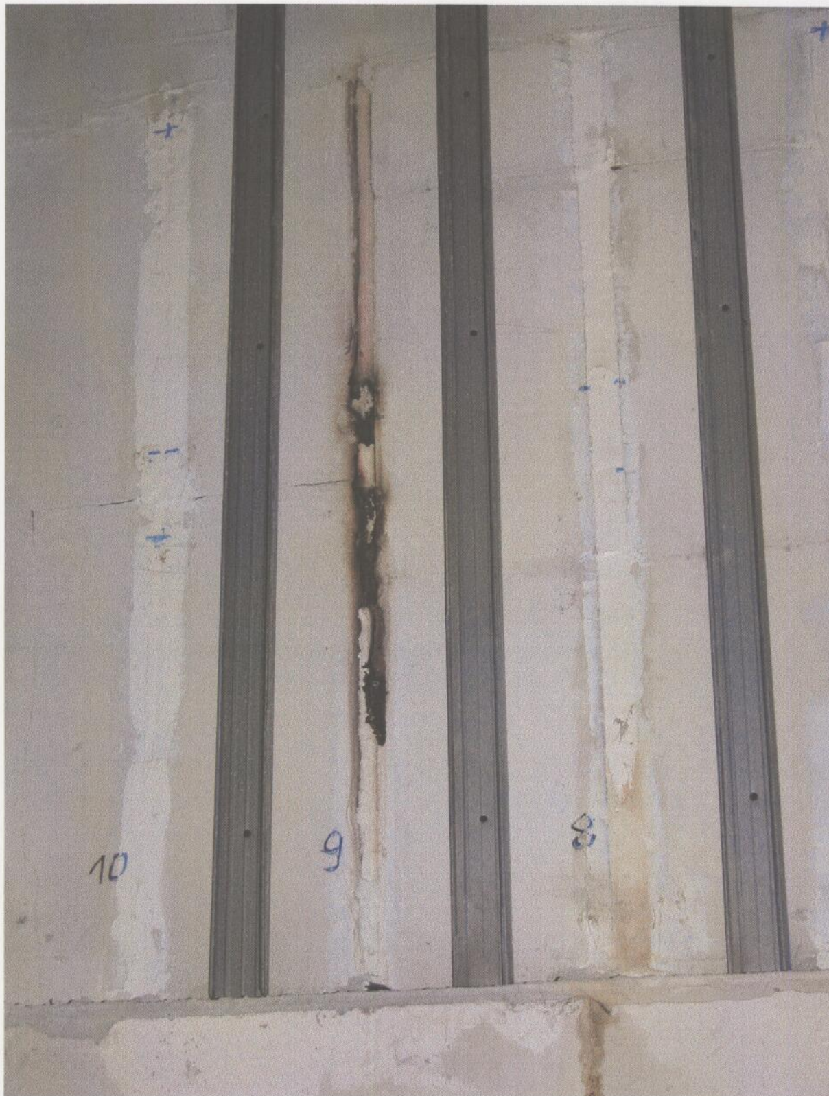
Fot. 32. Widok elementu próbnego od strony nienagrzewanej po badaniu - złącza 10, 9, 8
