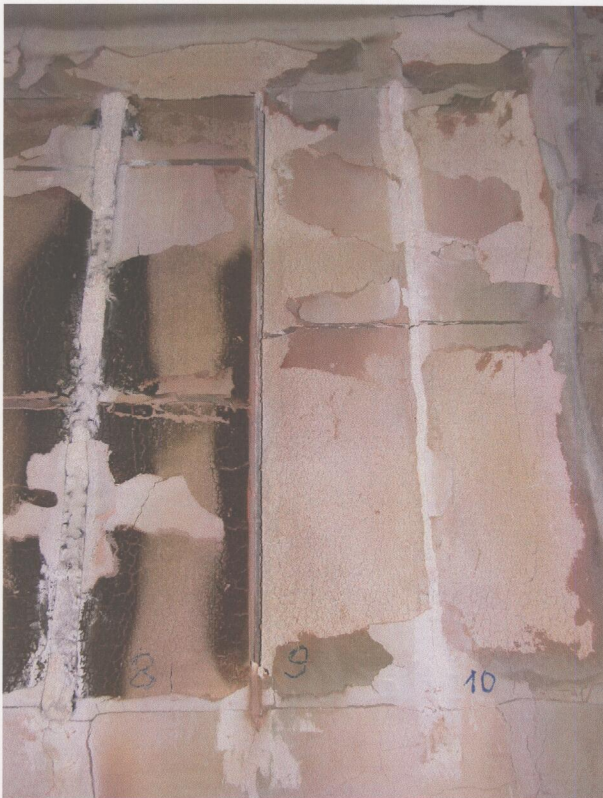
Fot. 24. Widok elementu próbnego od strony nagrzewanej po badaniu - złącza 8, 9 i 10
