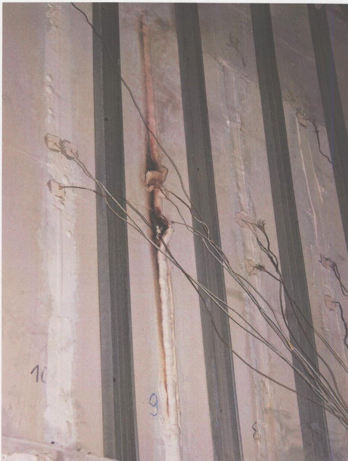
Fot. 16. Widok elementu próbnego w 241 minucie badania, od strony nienagrzewanej - szczegół ilustrujący zachowanie się uszczelnienia złącza 9
