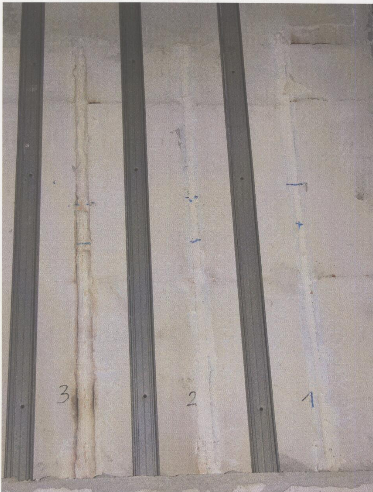
Fot. 28. Widok elementu próbnego od strony nienagrzewanej po badaniu - złącza 3, 2 1
