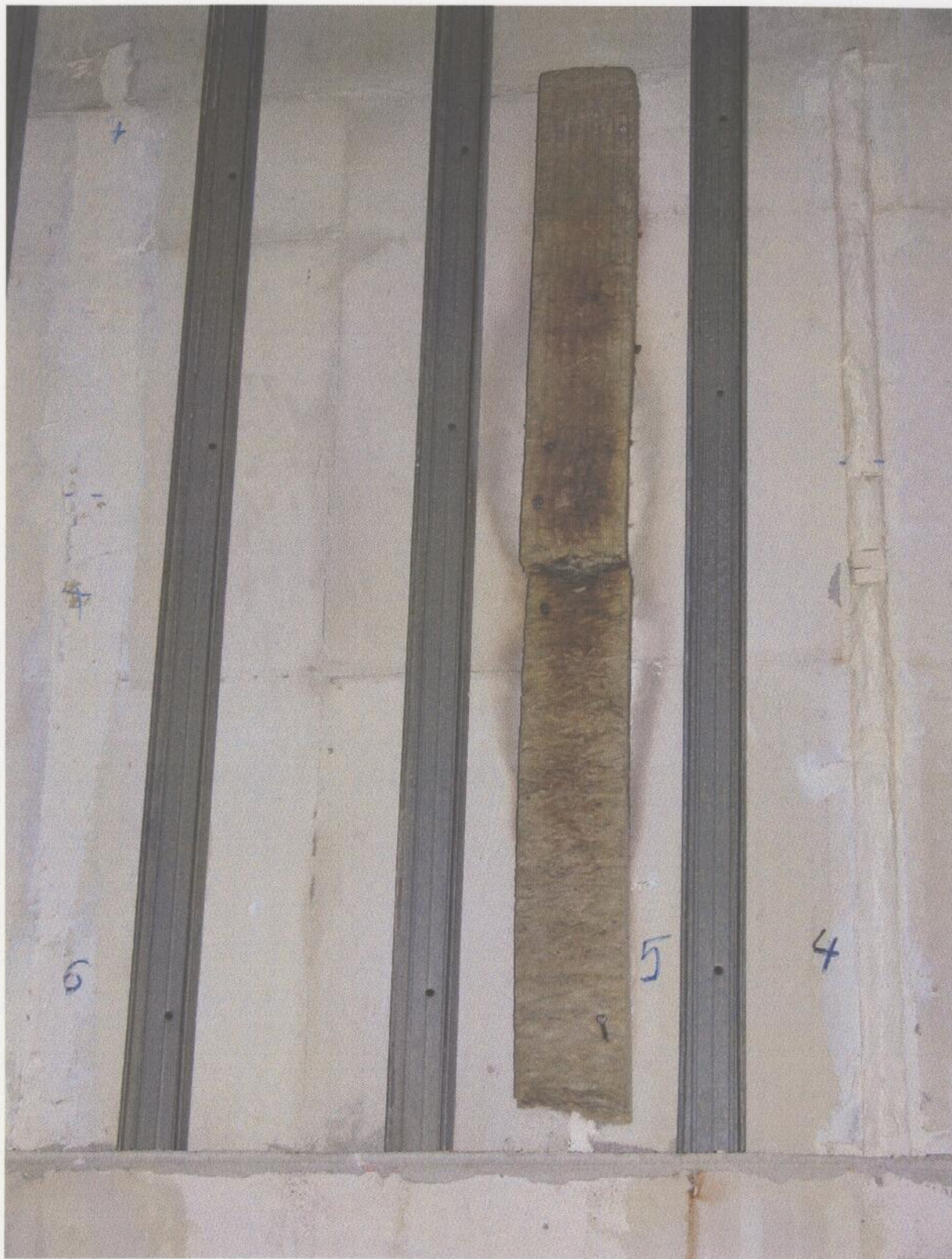
Fot. 29. Widok elementu próbnego od strony nienagrzewanej po badaniu - złącza 6, 5, 4
