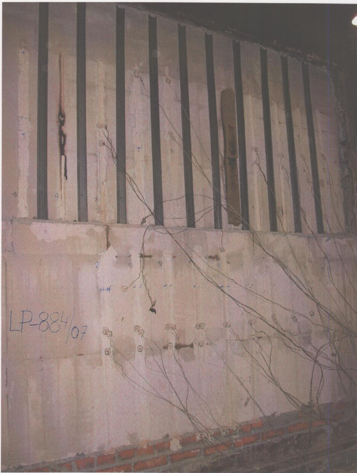
Fot. 20. Widok elementu próbnego od strony nienagrzewanej bezpośrednio po zakończeniu badania
