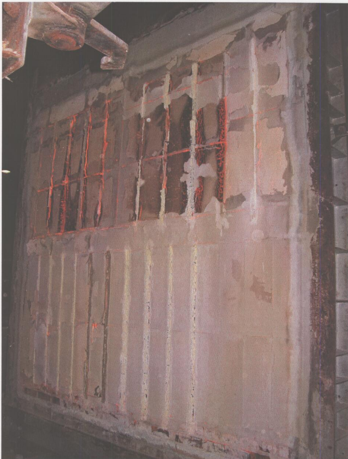
Fot. 18. Widok elementu próbnego od strony nagrzewanej bezpośrednio po zakończeniu badania
