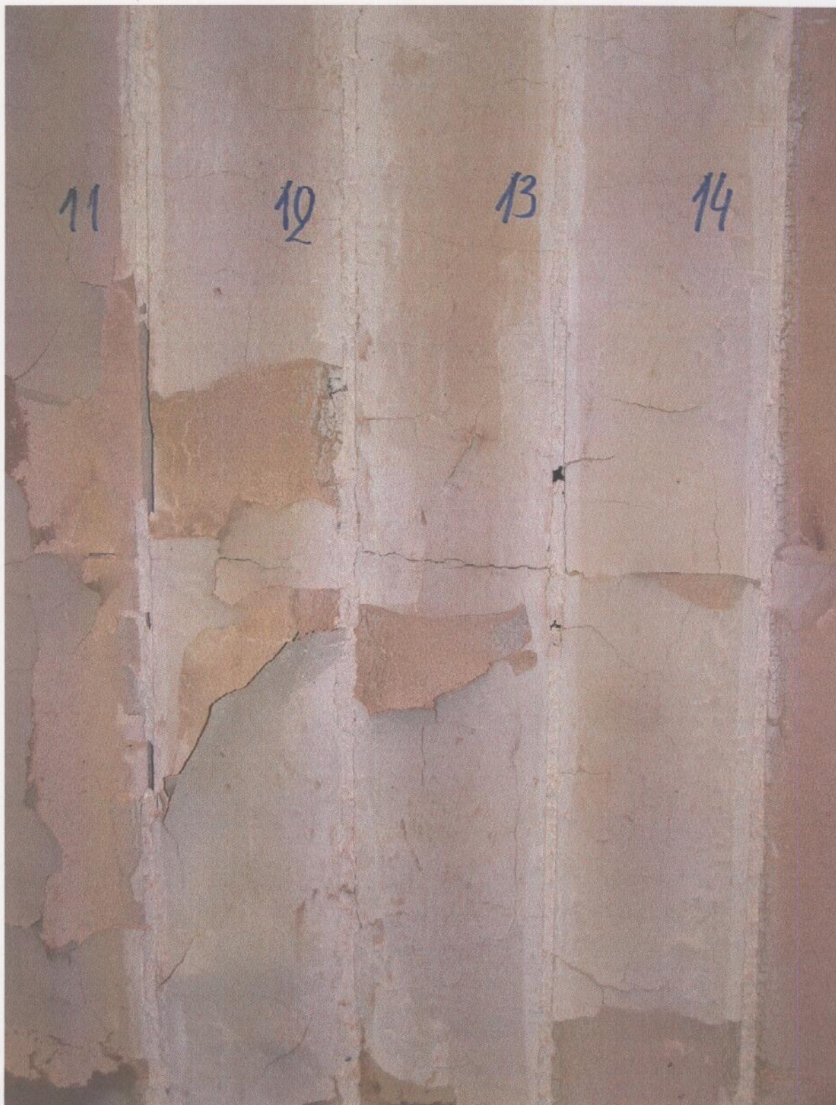
Fot. 25. Widok elementu próbnego od strony nagrzewanej po badaniu - złącza 11, 12, 13 i 14
