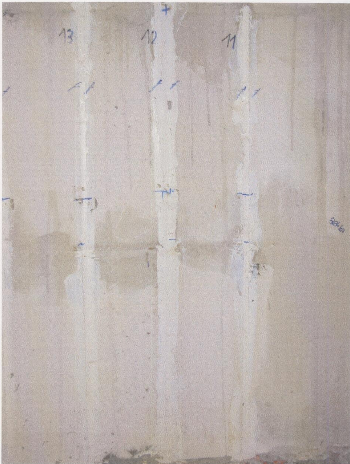
Fot. 33. Widok elementu próbnego od strony nienagrzewanej po badaniu - złącza 13, 12, 11
