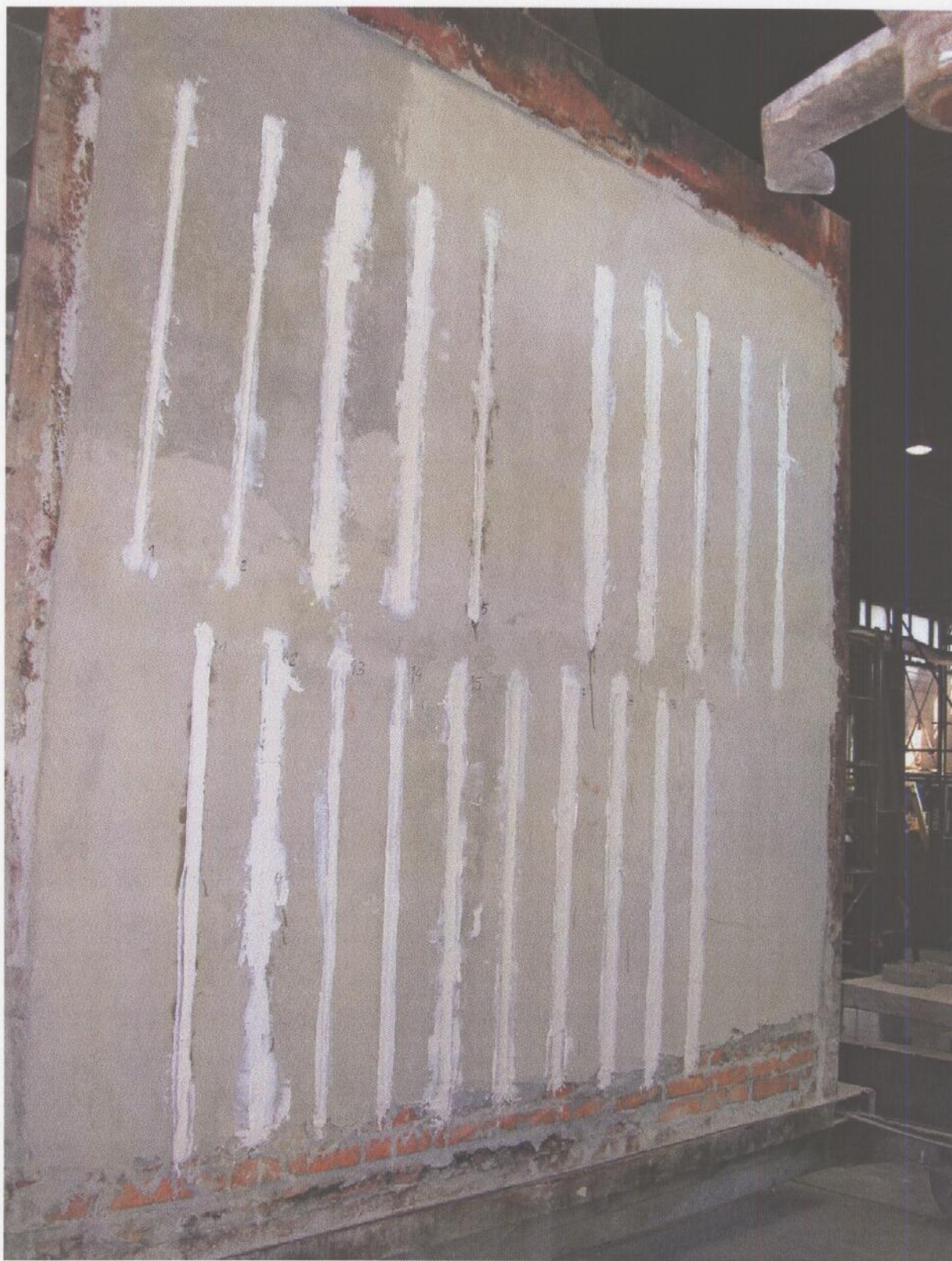
Fot. 2. Widok elementu próbnego przed badaniem od strony nagrzewanej
