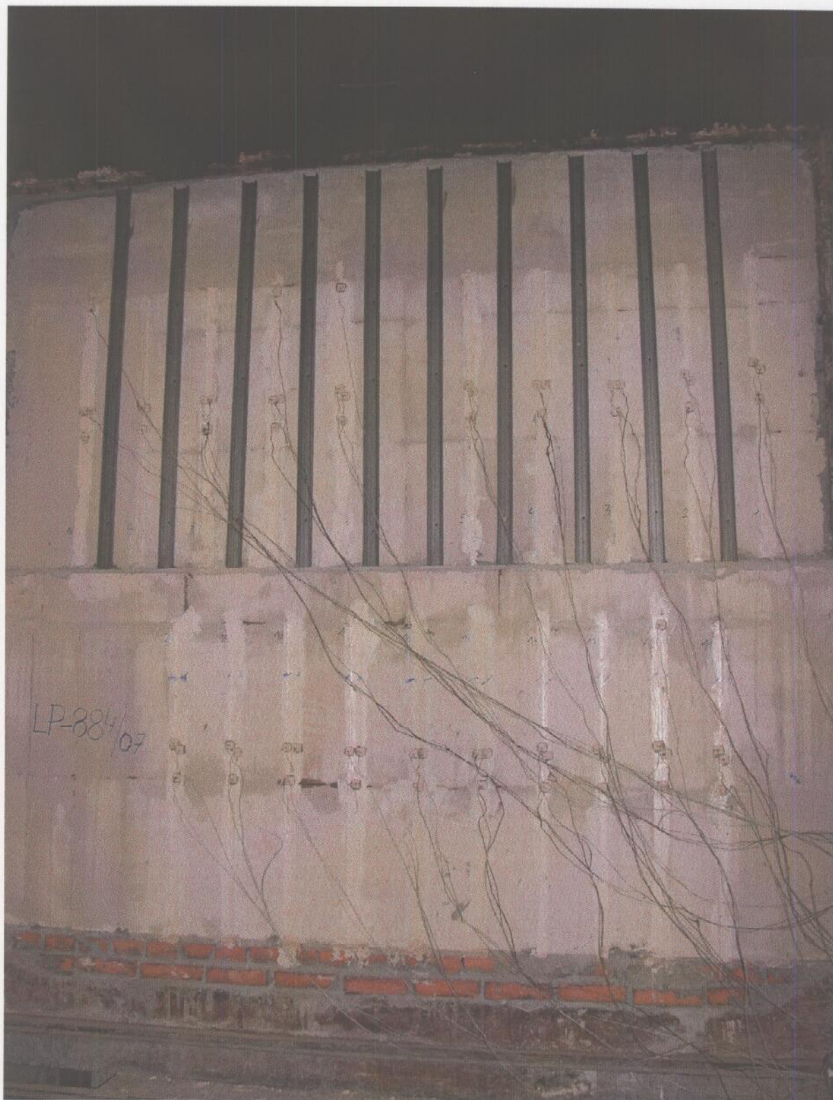
Fot. 8. Widok elementu próbnego w 150 minucie badania, od strony nienagrzewanej
