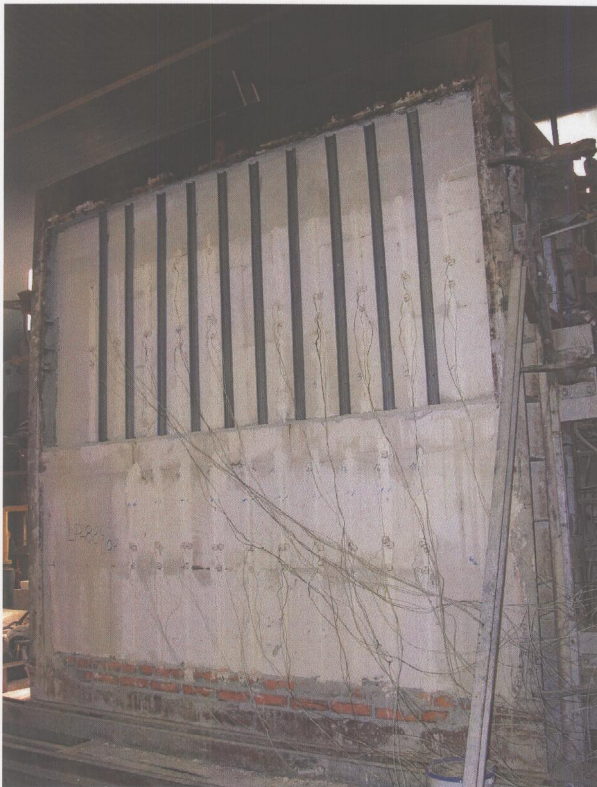
Fot. 7. Widok elementu próbnego w 123 minucie badania, od strony nienagrzewanej
