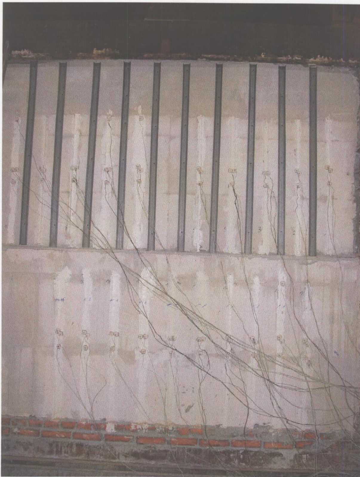
Fot. 1. Widok elementu próbnego przed badaniem od strony nienagrzewanej
