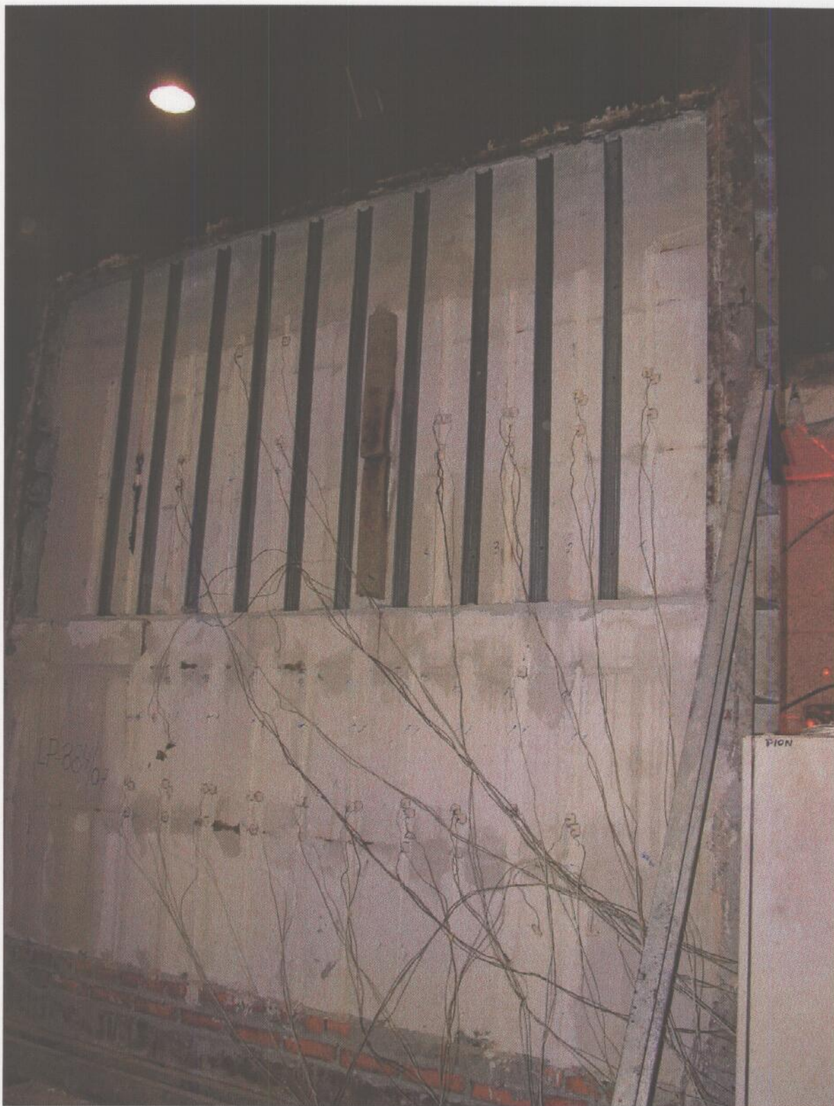
Fot. 19. Widok elementu próbnego od strony nienagrzewanej bezpośrednio po zakończeniu badania
