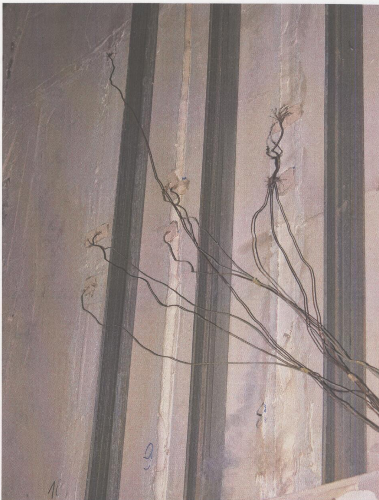
Fot. 13. Widok elementu próbnego w 220 minucie badania, od strony nienagrzewanej - szczegół uszczelnienia złączy 10, 9 i 8
