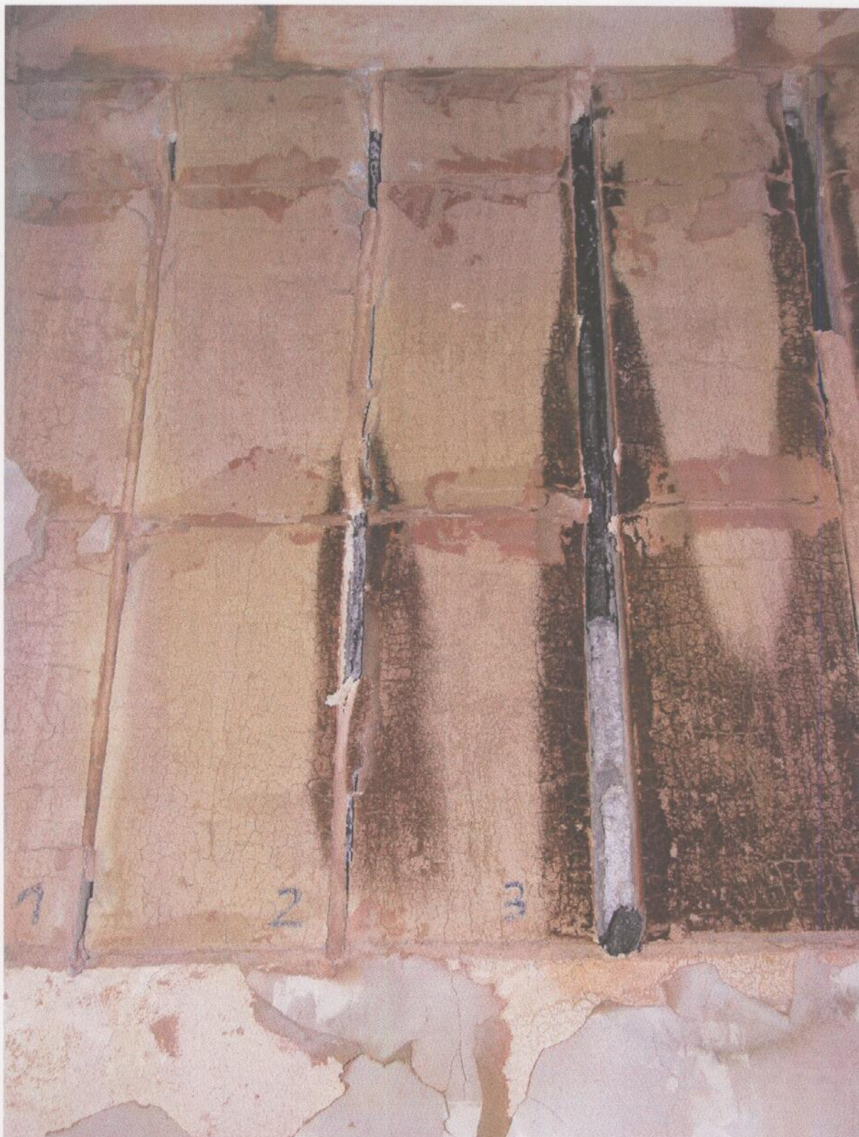
Fot. 21. Widok elementu próbnego od strony nagrzewanej po badaniu - złącza 1, 2 i 3
