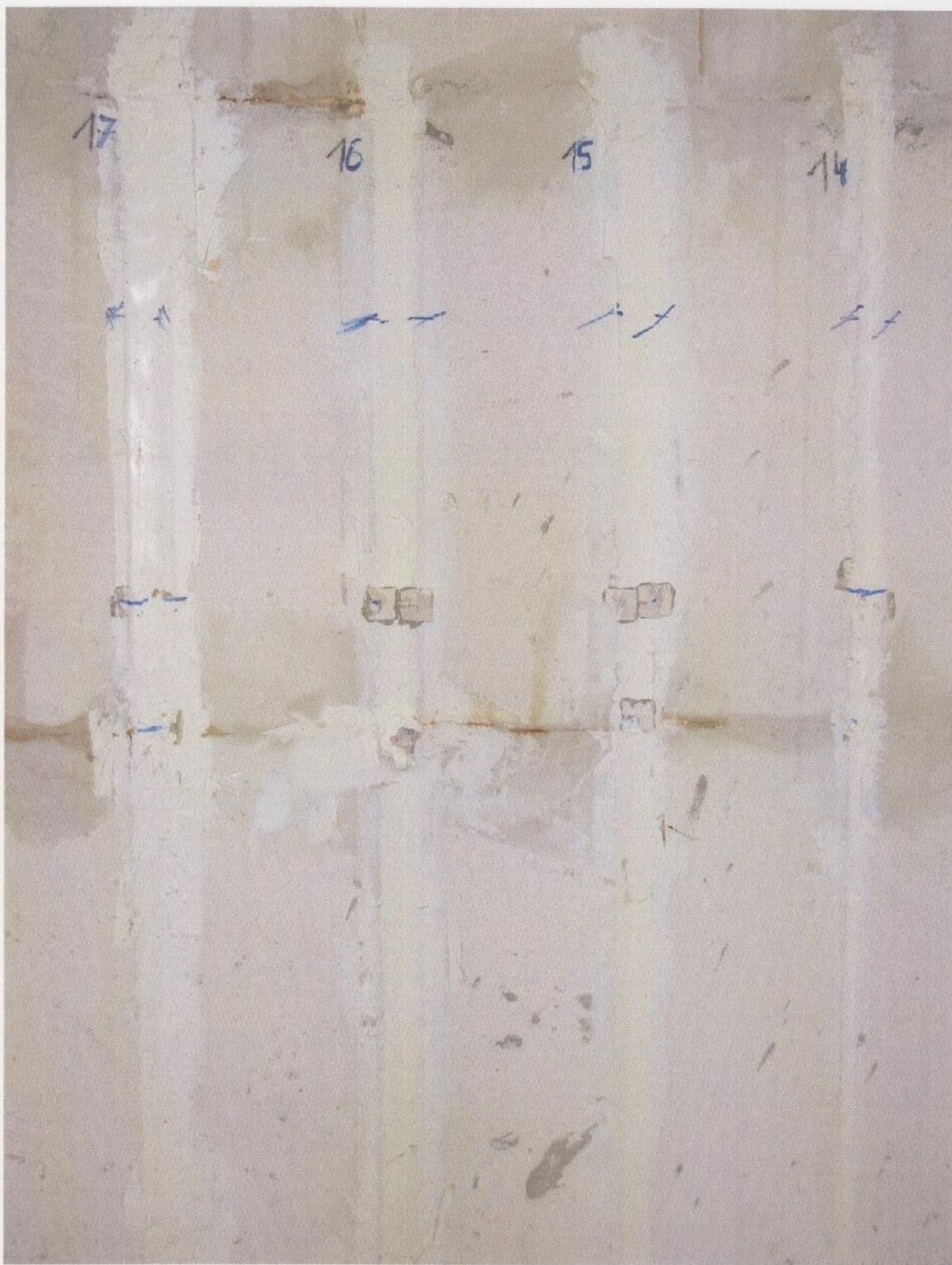
Fot. 34. Widok elementu próbnego od strony nienagrzewanej po badaniu - złącza 17, 16, 15, 14
