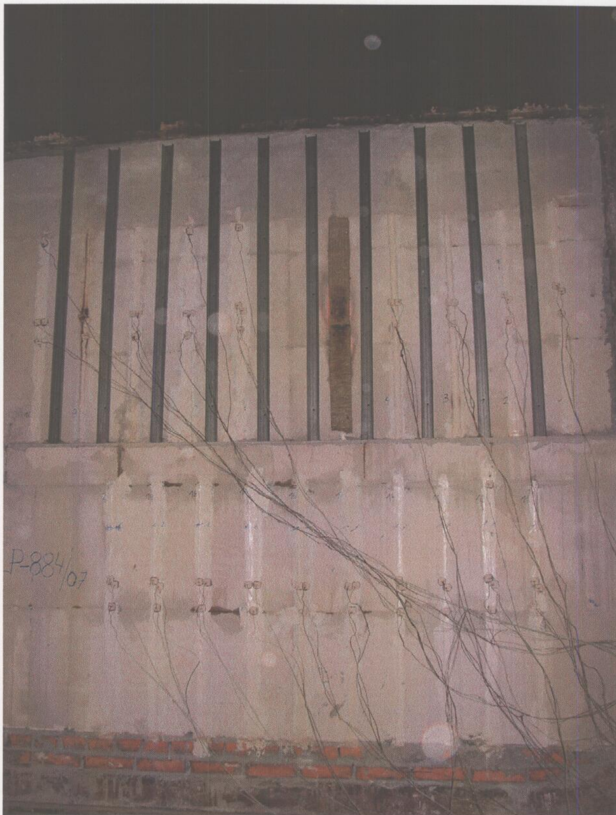
Fot. 15. Widok elementu próbnego w 241 minucie badania, od strony nienagrzewanej
