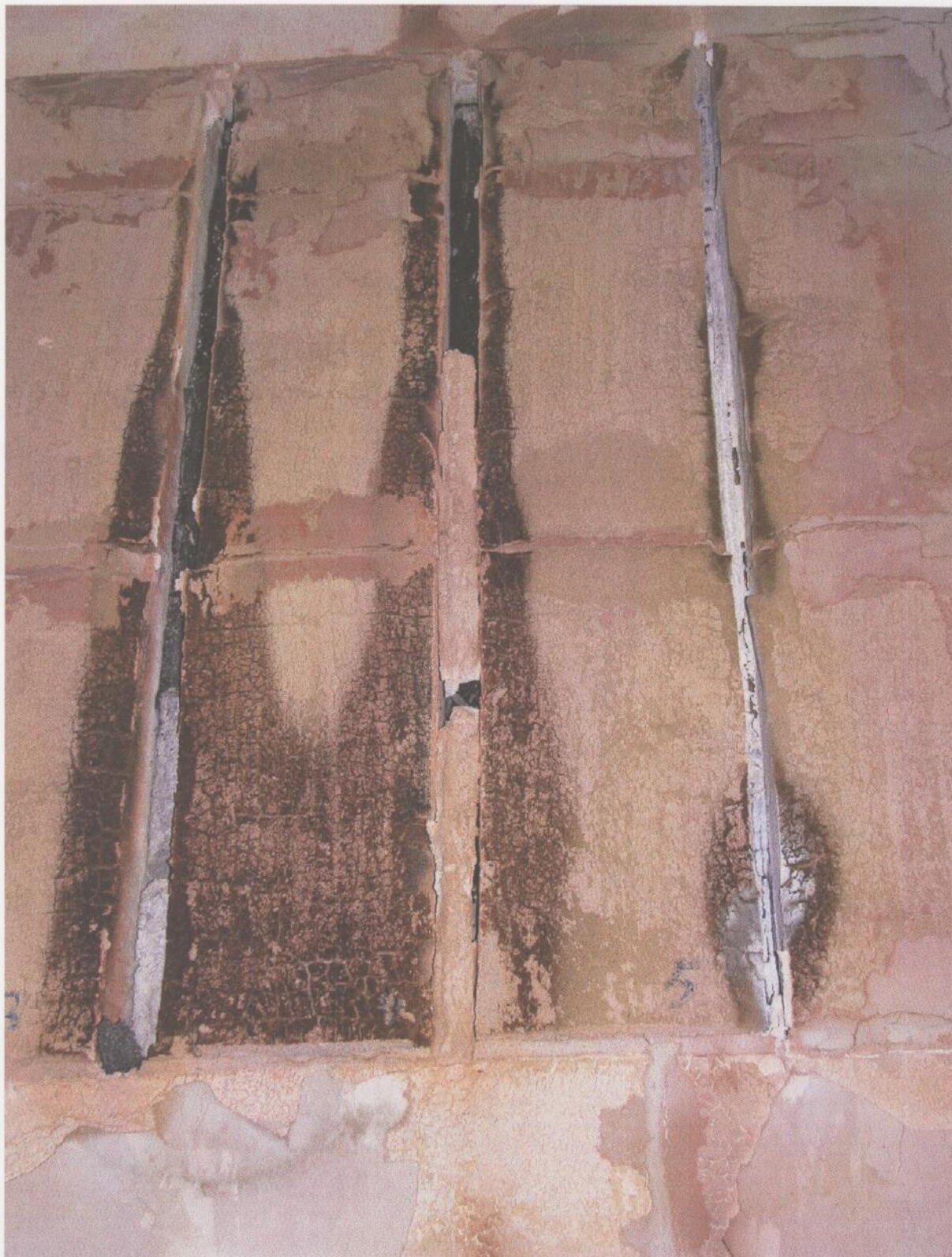
Fot. 22. Widok elementu próbnego od strony nagrzewanej po badaniu - złącza 3, 4 i 5
