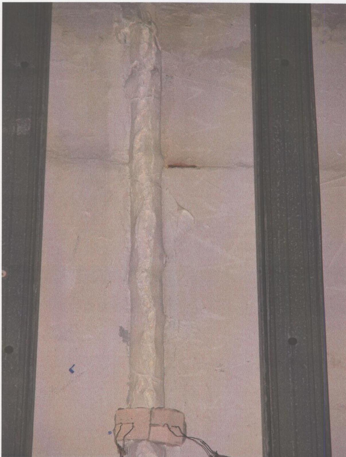
Fot. 12. Widok elementu próbnego w 220 minucie badania, od strony nienagrzewanej - szczegół ilustrujący spęczenie uszczelnienia złącza 4
