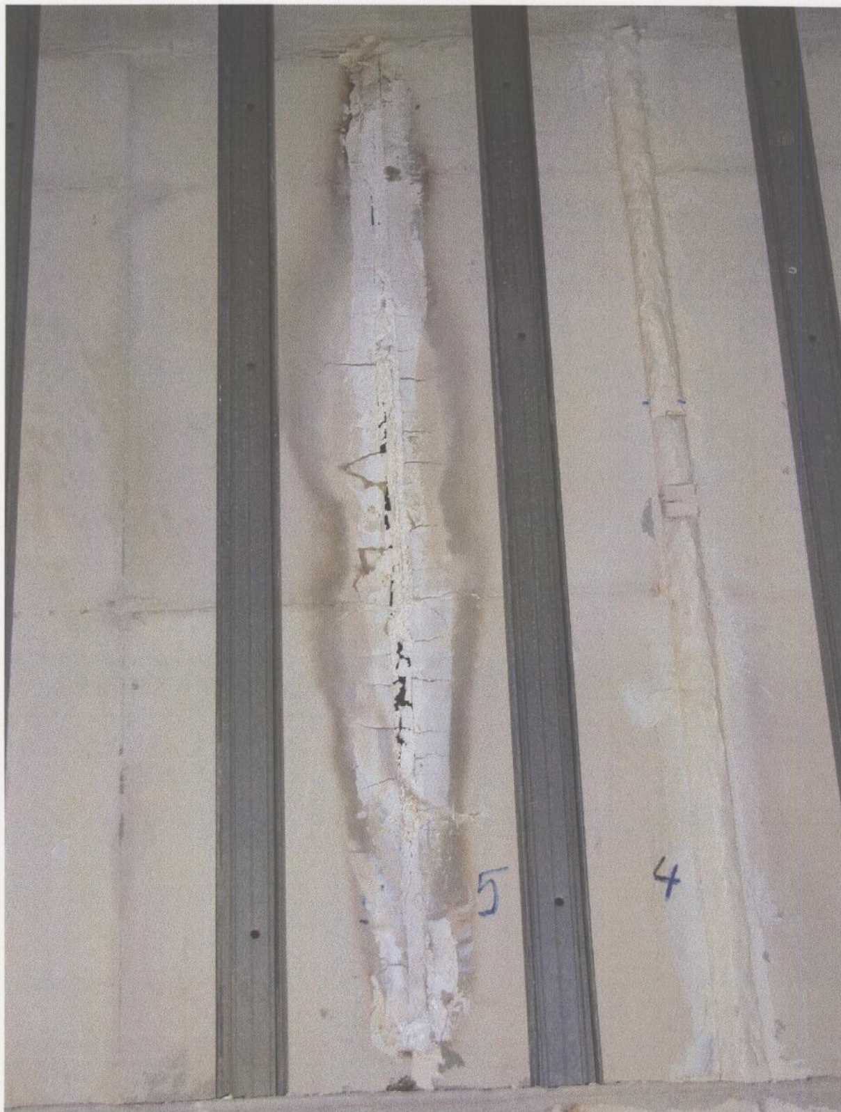
Fot. 30. Widok elementu próbnego od strony nienagrzewanej po badaniu – szczegół ilustrujący zachowanie się uszczelnienia złącza 5
