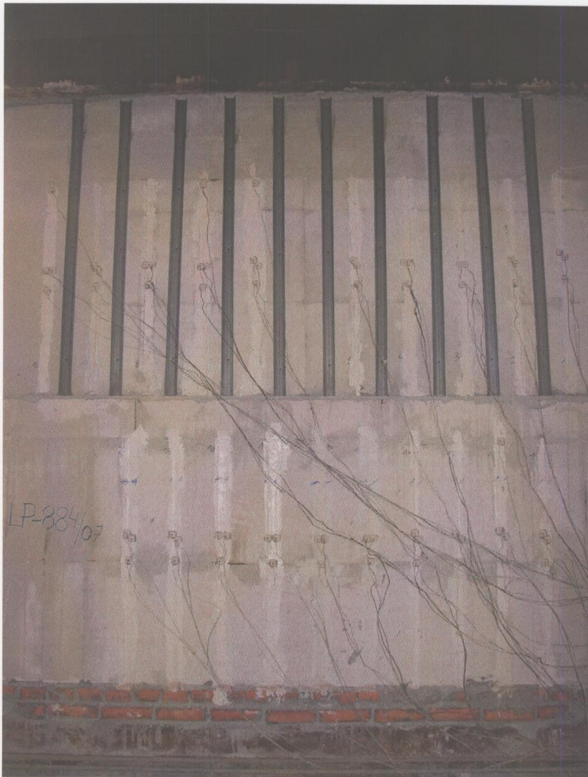
Fot. 6. Widok elementu próbnego w 91 minucie badania, od strony nienagrzewanej
