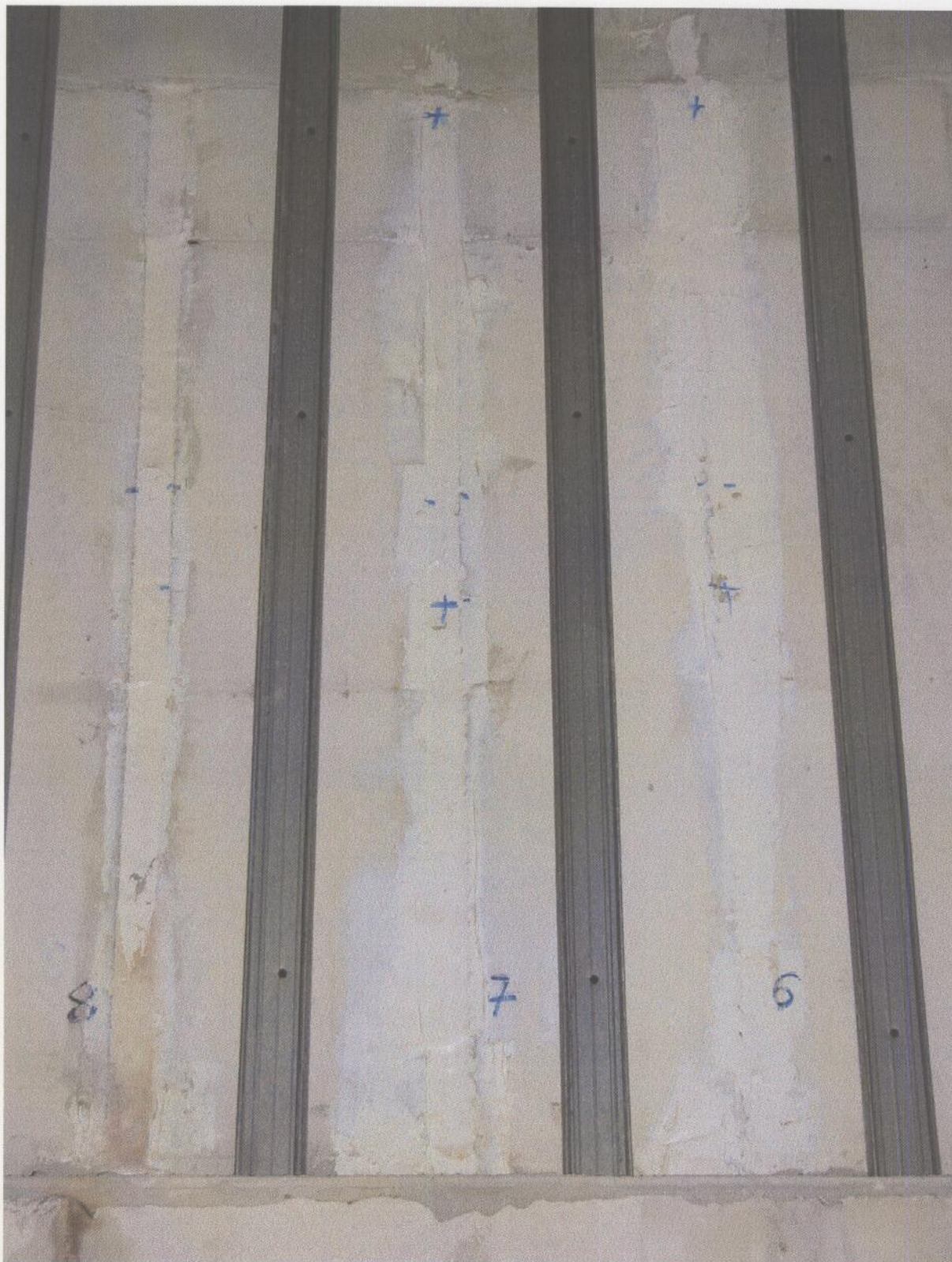
Fot. 31. Widok elementu próbnego od strony nienagrzewanej po badaniu - złącza 8, 7, 6
