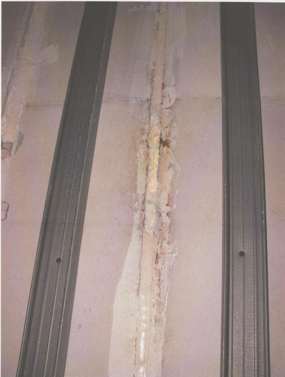
Fot. 14. Widok elementu próbnego w 227 minucie badania, od strony nienagrzewanej - szczegół ilustrujący zachowanie uszczelnienia złącza 5
