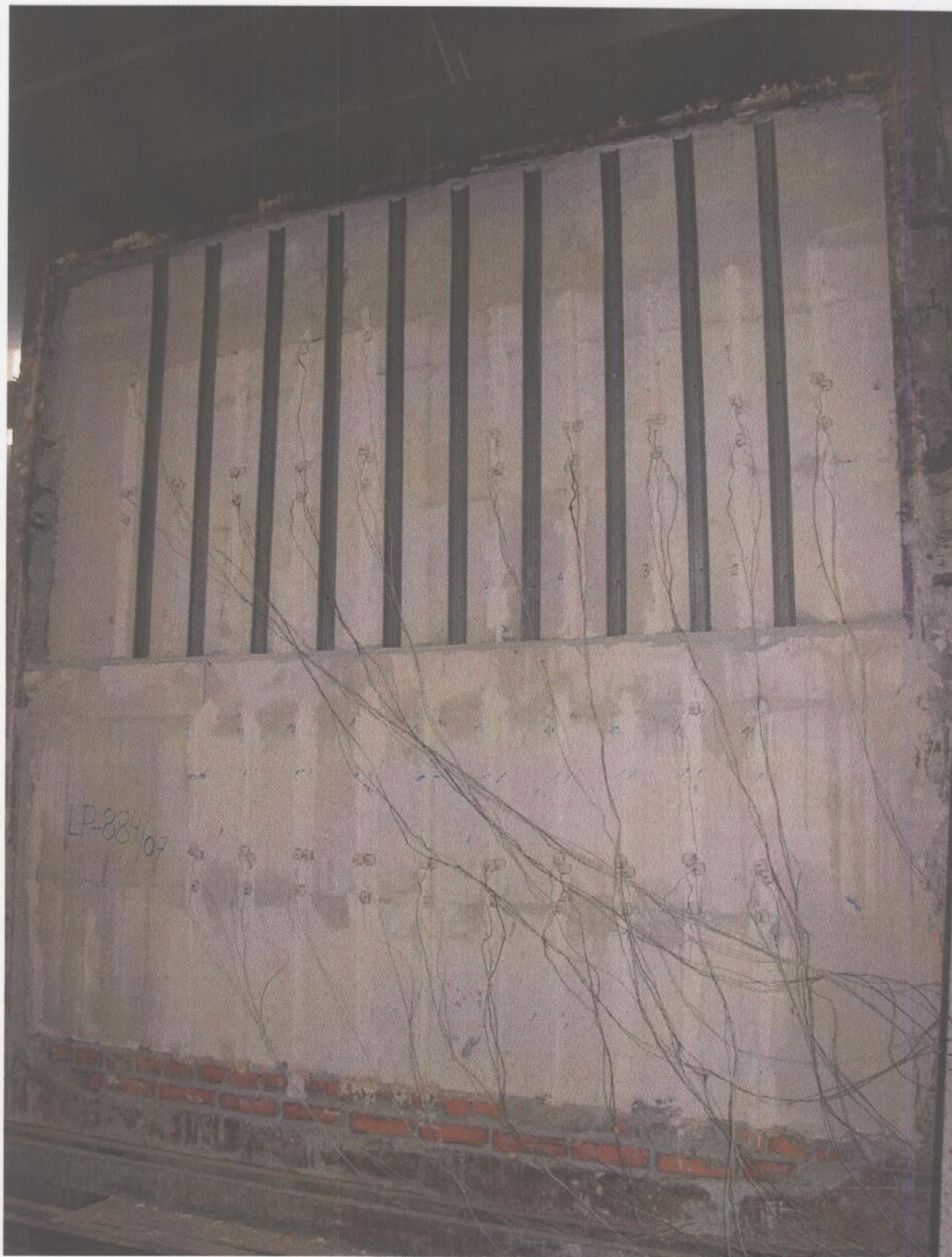
Fot. 5. Widok elementu próbnego w 68 minucie badania, od strony nienagrzewanej
