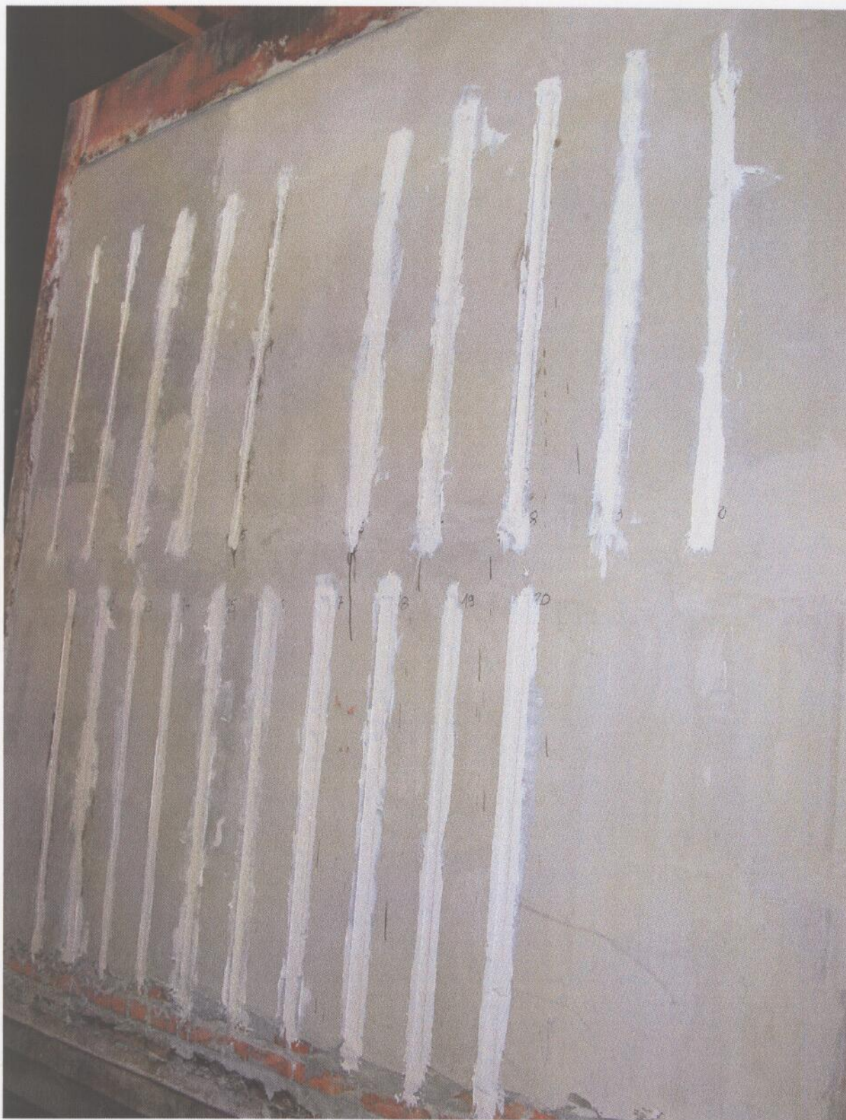
Fot. 3. Widok elementu próbnego przed badaniem od strony nagrzewanej
