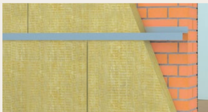
Izolace SUPERROCK, ROCKTON vložena mezi vodorovný rošt
