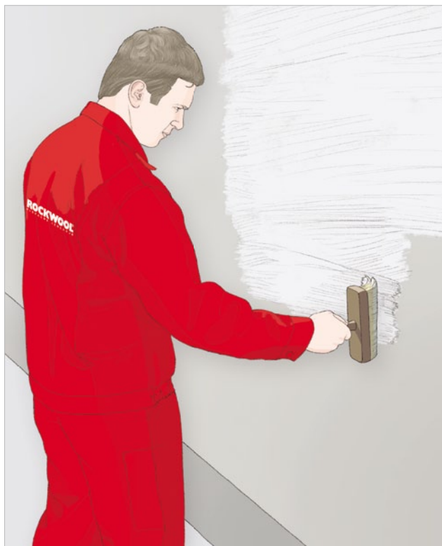
Nanesení penetračního nátěru PT-ECOROCK Grunt M nebo S-T.
