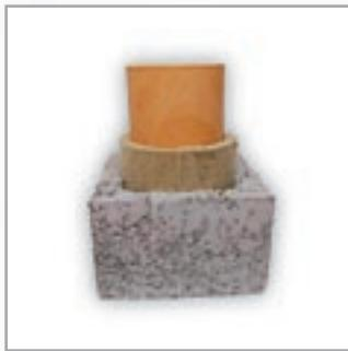
Šamotové vložky tl. 15mm jsou spojovány speciálním tmelom, který spojuje vložky na chemické bázi. Tento tmel zaručuje pevnost a trvanlivost spoje jak při vysokých teplotách, tak při kondenzaci plynových spotřebičů. Šamotový komínový čistič je překryt uzávěrem kondenzátu s pružinou, která pevně uzavírá komínový průduch.
