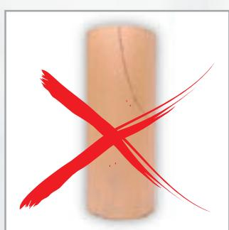
Před vlastní montáží se přesvědčíme, zda-li jsou použité prvky kompletní, bez viditelných prasklin a trhlin. U šamotových komínových vložek doporučujeme před zabudováním do komína poklepem zjistit „zdraví“ vložky - poškozenou vložku poznáme podle dutého a chrastivého zvuku (neviditelné mikrotrhliny), zvuk musí být zvonivý, neodpovídající vložku nepoužijeme. Dodatečná výměna vložek v již postaveném komínu je nesrovnatelně složitější a finančně náročnější, než výměna poškozené vložky za novou.
