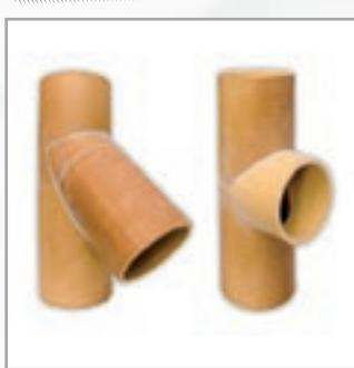
Komínový sopouch KS je vyráběn s úhlem napojení 90°, popř. 45°. Sopouch je vždy izolován izolací sopouchu IS, která dovoluje částečnou dilataci vnitřních šamotových vložek. Pro snadnější napojení spotřebičů do šamotového průduchu používáme redukci z vysokojakostní nerezové oceli APR, jejíž provedení zamezí praskání sopouchu, tak častém při použití běžné černé kouřoviny s těsnícím provazcem.
