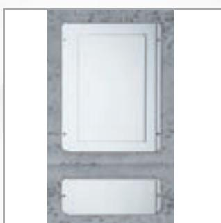
Na komínové tvárnici jsou osazeny dvířka ADK s nekorozivním provedením pantů. Řešení s pruživým uzávěrem kondenzátu dovoluje použití komínových dvířek i v místech, kde dochází k rozdílné dilataci šamotových vložek a vnější tvárnice (typicky u druhého, půdního čističe). Do spodní části komínu je nutno osadit mřížku pro zadní větrání AMK. Tato mřížka je vyrobena ve stejném šířkovém modulu, jako čistící dvířka a tvoří spolu estetický komplet.
