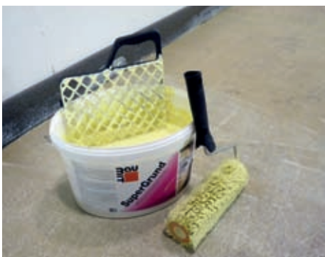
Nanesení základního nátěru v podobě kontaktního můstku Baumit SuperGrund
