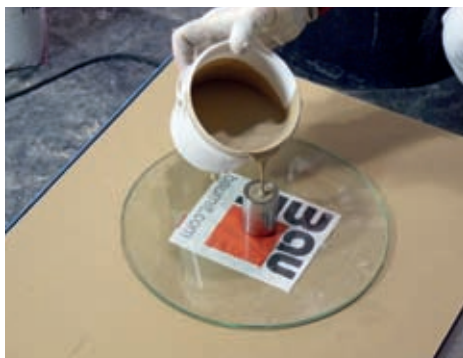
Ověření správné konzistence lité směsi rozlívovou zkouškou.
