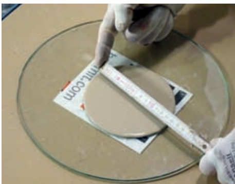
Použití předepsané rozlívové nádoby, hodnota výsledného rozlív musí být 130 \pm 5 mm.
