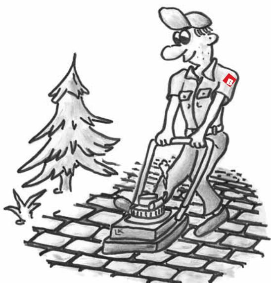
Položenou dlažbu zasypat křemičitým pískem a vmést do spár. Dlažbu zavibrovat vibrační deskou, jejíž pracovní plochu opatřete podložkou z tvrdé pryže. Hutněním se srovnají přípustné výškové tolerance jednotlivých kamenů.
