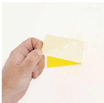
Obr.1 Příp. zkouška přídržnosti podkladních vrstev.
