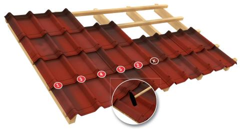
Kotvení krytiny se provádí do každé horní vlny krytiny (mezi drážky) ve stanoveném pořadí v počtu 18 ks/m<sup>2</sup>. Boční 6. vlnu (x) přikotvíte až po překrytí další šablony!
