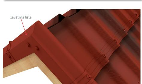
1 Hřebenáč úzký lze použít pouze při sklonu střechy 17°–30°. Při nižším nebo vyšším sklonu se použije standardní hřebenáč bez použití podhřebenového prvku.
