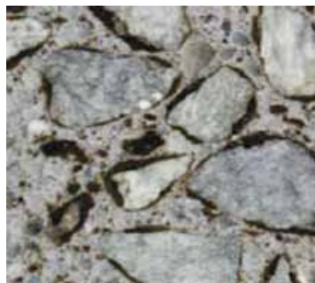
Průřez OptiPhalt
