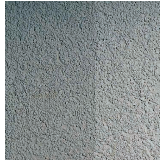
Testovací plocha s nátěrem Disboxan 450 na disperzní omítku po 18měsíčním působení povětrnostních podmínek v průmyslové oblasti (vpravo) a bez něho (vlevo)
