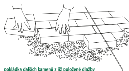
pokládka dalších kamenů z již položené dlažby
