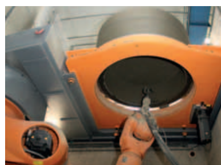
frézování nástupnic a žlabů šachtových den robotickou rukou Primuss-Prinzing
