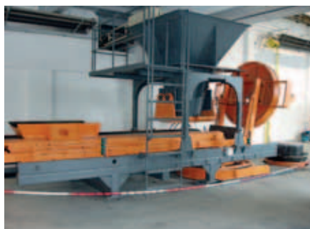
vibrolis pro výrobu polotovarů šachtových den
