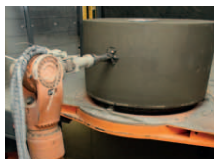
frézování vtokových a výtokových otvorů šachtových den robotickou rukou Primuss-Prinzing
