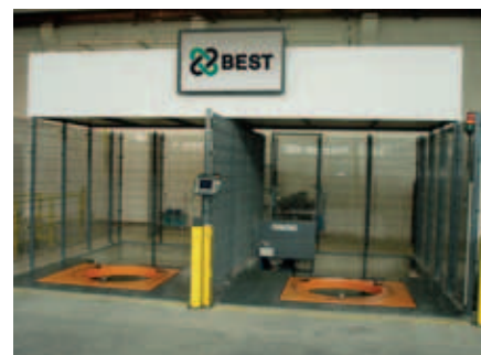
dvě stanoviště pro robotické frézování šachtových den BEST technologií Primuss-Prinzing
