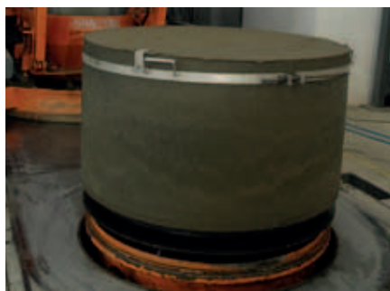
vibrolisovaný polotovar šachtového dna
