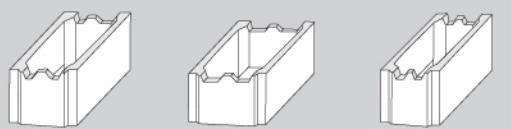
Rychlosť. Tak by se dala jedním slovem shrnout stavba z betonových základových tvárníc, které se používají na výstavbu základů, svislých nosných i nenosných konstrukcí zdí a opěrných zdí. Vnitřní otvor tvárnice se zalévá betonovou směsí, čímž se zajistí její pevnost. Stavby ze základových tvárnic si stále ponechávají přirozený dojem.
